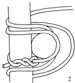
Faire trois tours d'assemblage : comme le montrent les figures 2 et 3, chaque tour passe à l'extérieur du précédent sur la pièce portante et à l'intérieur sur la pièce portée. Il faut toujours tendre la corde au fur et à mesure.
